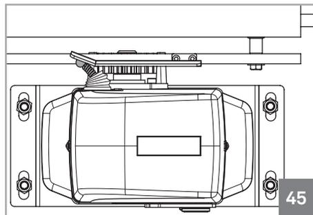
**01** • Collocare la piastra di fine corsa di apertura nella cremagliera in modo da azionare il fine corsa nel motore, prima che il cancello arrivi alla battuta di apertura. La piastra deve poggiare sulla molla di finecorsa come visibile nell'immagine 45.
