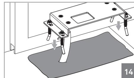
**04** • Fissare la piastra con le viti nella base di calcestruzzo ancora fresco e livellarla orizzontalmente con una livella. Allinearla inoltre parallelamente al cancello, mantenendo una distanza di 60 mm da esso, come riportato nella figura 16.
