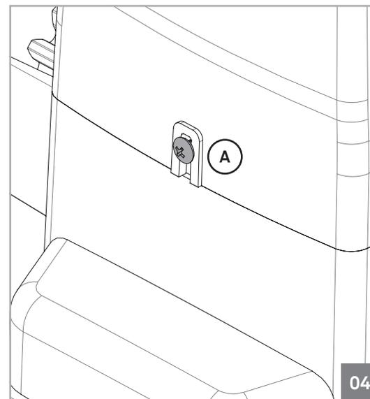
Durante l'installazione, è necessario aprire il coperchio del motore per accedere ai vari elementi al suo interno. Per questo, allentare un pò le 2 viti identificate con (A) finché il coperchio rimane libero e può essere rimosso.
