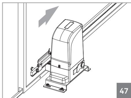
**02** • Applicare le viti DIN912 M5 x 12 in dotazione con gli accessori finché la piastra di fine corsa non rimanga saldamente avvitata alla cremagliera.
